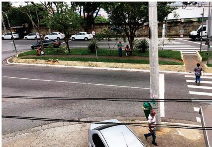
**Foto 9: Av. Nagib Farah Maluf junto a R. Jardim Tamoio – travessia frequentemente desrespeitada, com interferências e inexistência de rebaixamento de guias para deficientes nas calçadas e canteiros.**
