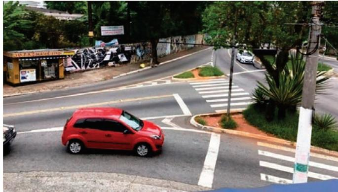
**Foto 11: canteiros com pavimento deteriorado, com interferências e sem rebaixamento de guia para deficientes.**
