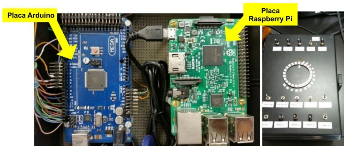
Figuras 17 e 18 – Protótipo que hospedou o 72C e operou um controlador simplificado (placas internas e caixa de testes)
