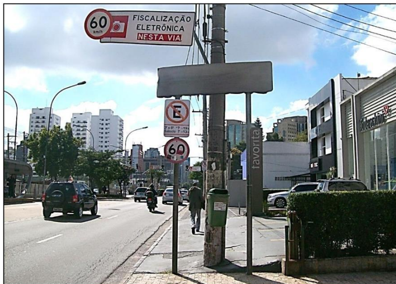
Figura 36 – Sinalização em excesso em uma única seção da via, com os postes interferindo na passagem de pedestres.
