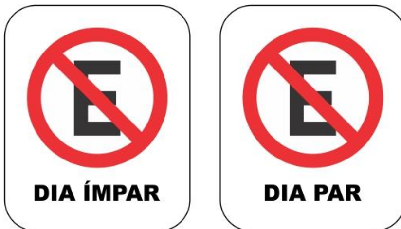
Figura 49 – Desenho esquemático das placas R-6a com complemento.
