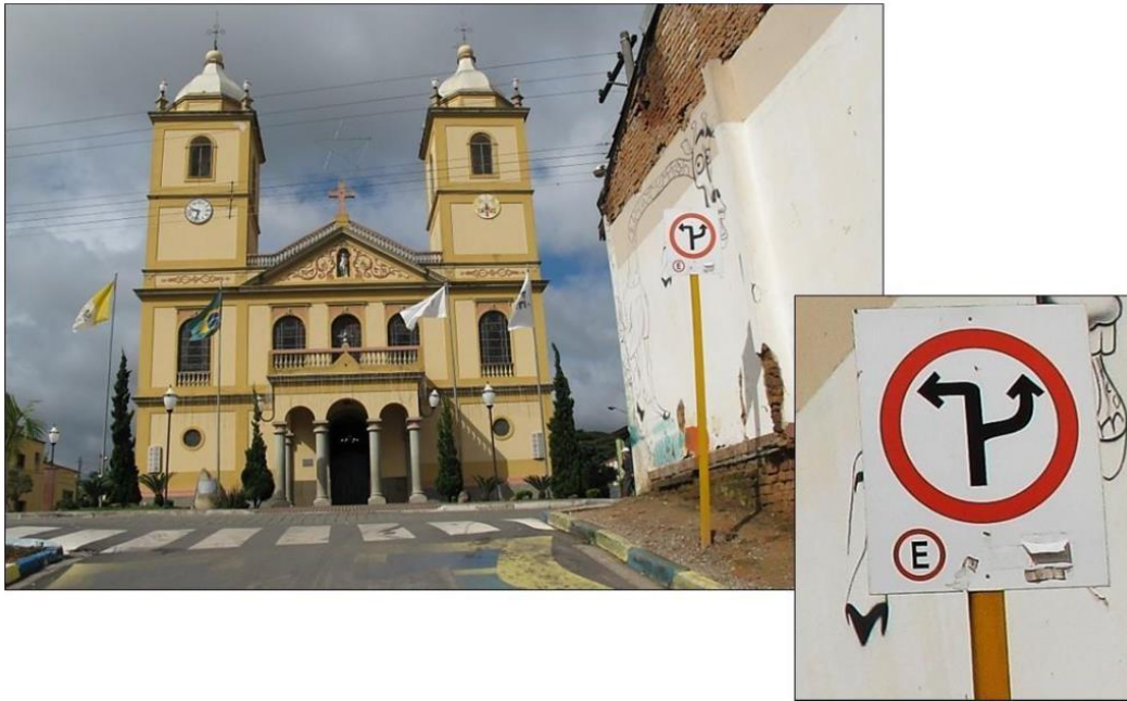
Foto 13 – Outro exemplo de placa não prevista no CTB. Aparentemente, a ideia foi juntar a regulamentação da circulação com um diagrama dos trajetos permitidos, em uma solução que, além de ilegal, também tem a clareza comprometida. No detalhe ao lado é possível notar um pequeno sinal indicando que ali é permitido estacionar (fotos: Marcelo Bobrovsky).
