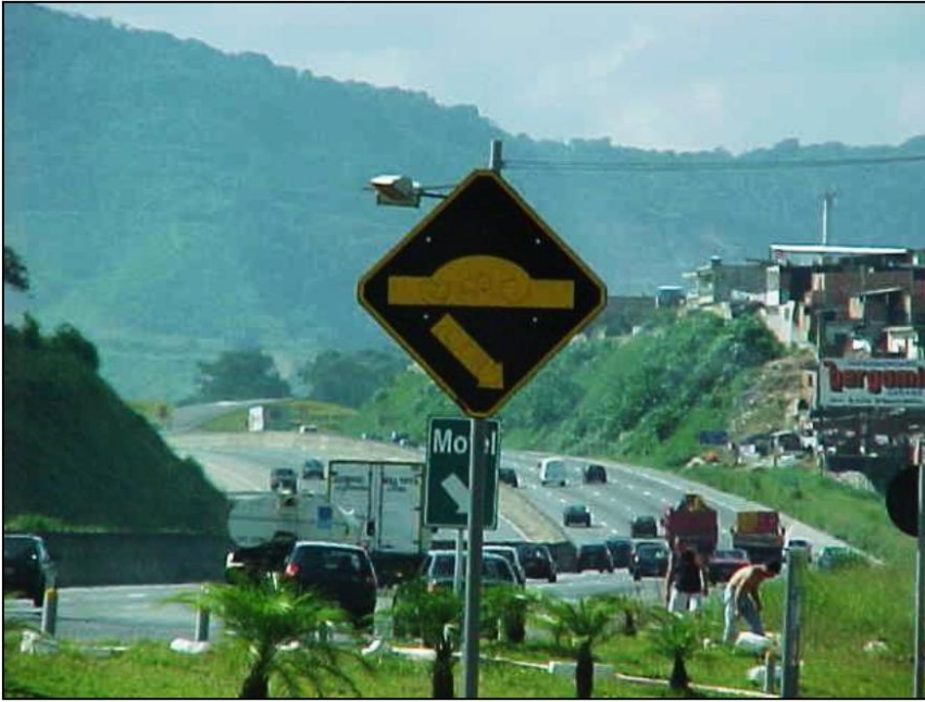
Figura 15 – Imagem de placa irregular/ilegal, pois difere da oficial. Um dos inúmeros exemplos que mostram que a sinalização de trânsito ainda não é tratada com o devido rigor em grande parte das cidades brasileiras.
