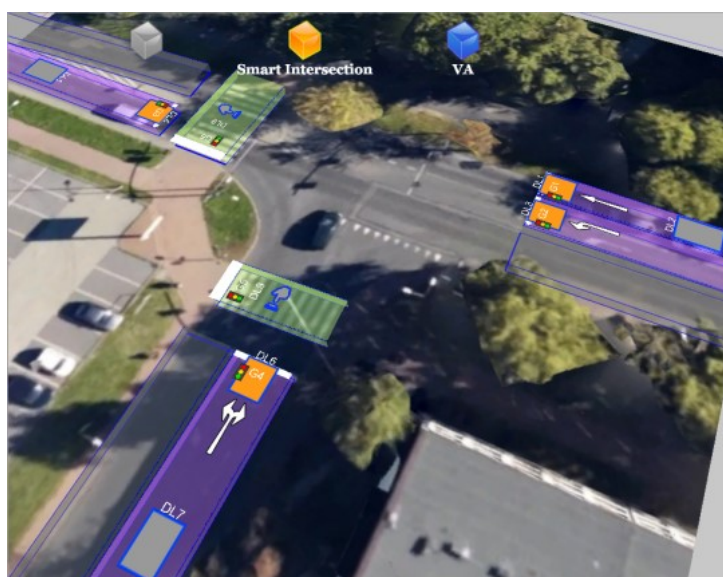
Figura 33 – Posicionamento dos detectores no SMART INTERSECTION
