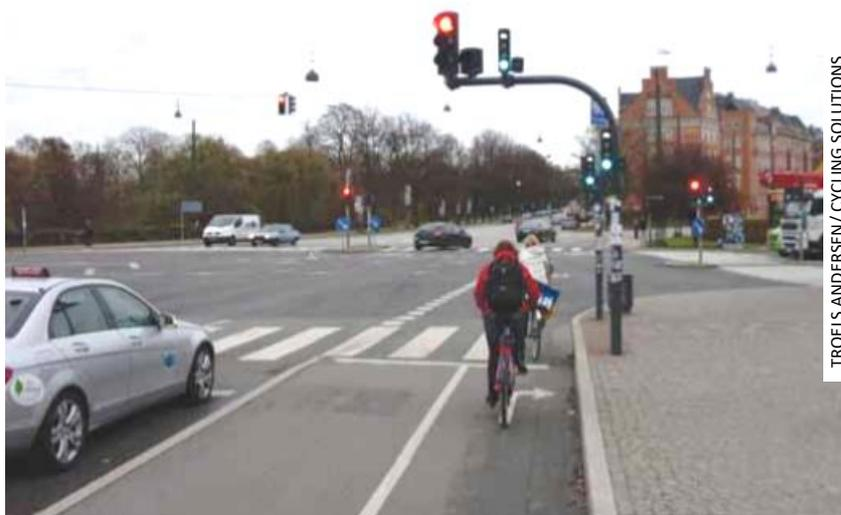
Figura 162: Travessia semaforizada em Copenhague com antecipação do verde de bicicleta. [Fonte: CCC, 2012]
