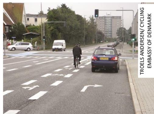
Figura 82: Ciclofaixa com faixa de conversão de veículos motorizados à direita na Dinamarca.
