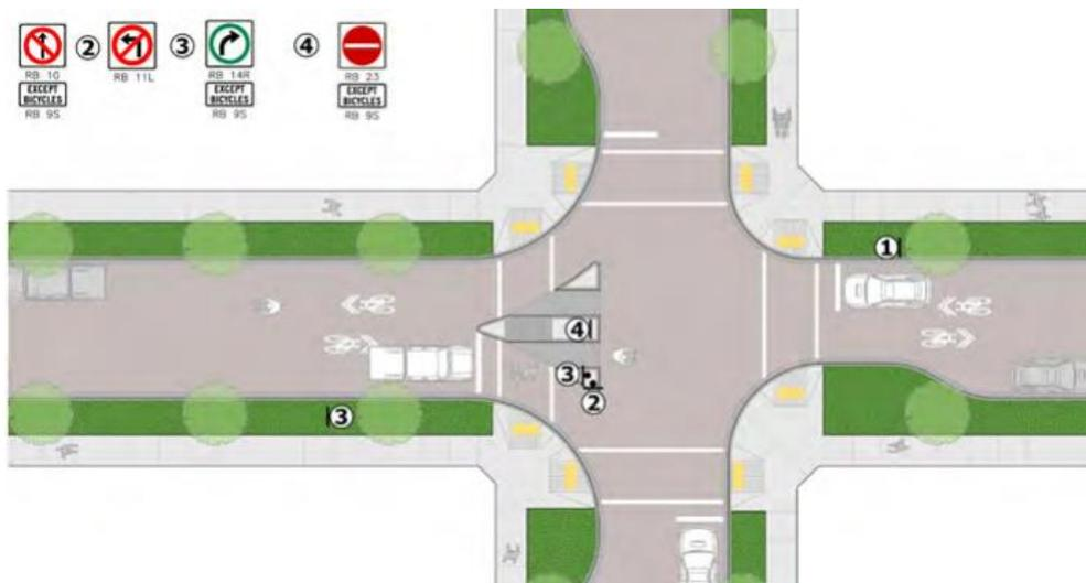
Figura 116: Ilhas "entra pela direita", "sai pela direita". [Fonte: British Columbia Min. of Transportation and Infrastructure]
