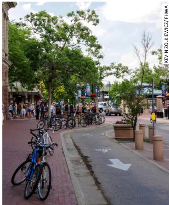
Figura 108: Conversão por fora em Boulder, EUA, utiliza o espaço extra na calçada para a construção de estacionamento para bicicletas.
