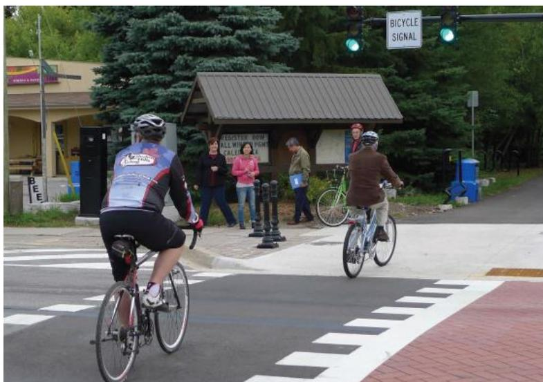
Figura 160: Exemplo de travessia com grupo focal para ciclistas. [Fonte: PBFDG]
