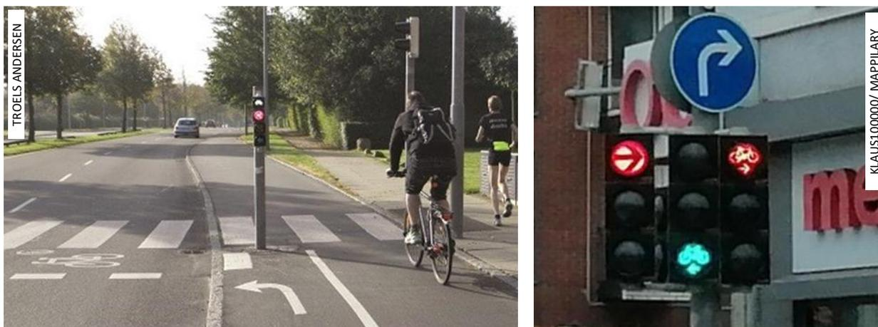
Figura 80: Esq. cruzamento em T, em que o ciclista é livre para seguir em frente, mas usa grupo focal com seta para a travessia em Odense, Dinamarca. Dir: grupos focais veicular e de ciclista com seta em Dortmund, Alemanha.
