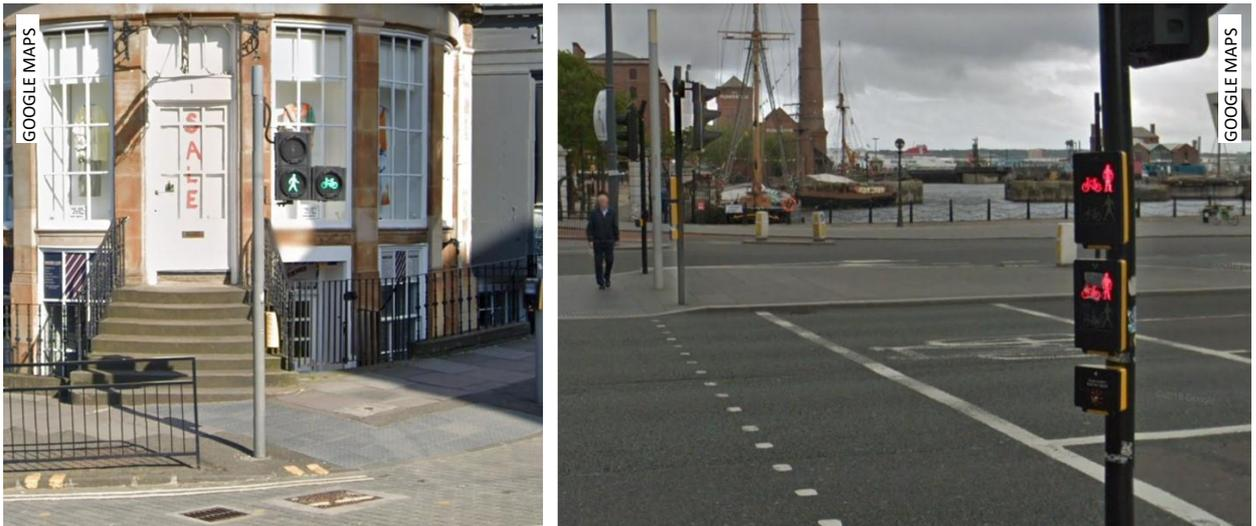
Figura 89: Travessia toucan. Modelo com um foco de ciclista no Reino Unido em Edimburgo (esq.) e com dois focos e dois grupos focais em Liverpool. Na parte inferior é possível ver a botoeira.
