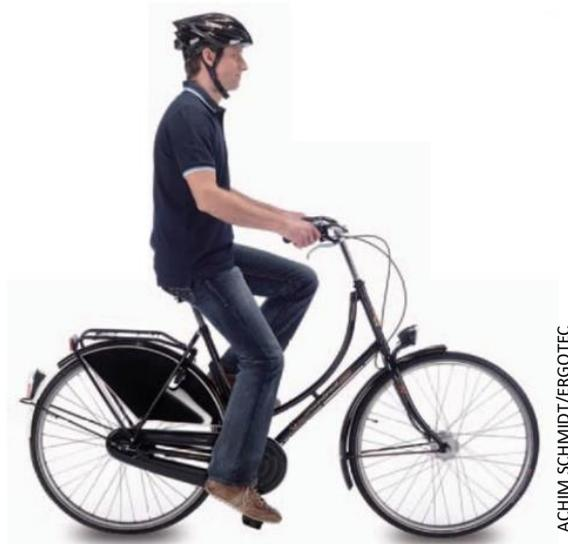
Figura 134: Posição holandesa (clássica): torso quase vertical, com guidão e manoplas próximas ao corpo e pedais recuados.
