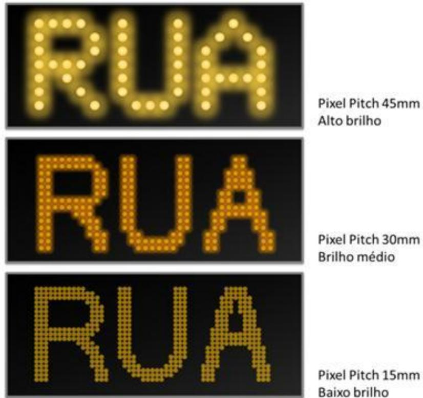
Figura 24 – Exemplos de pixel pitch
