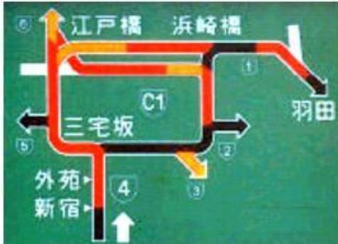
Figura 62 - Exemplo de PMV gráfico implantado em Tóquio. As áreas amarelas representam lentidão e as vermelhas representam congestionamento
