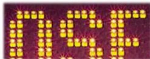
Figura 15 – Detalhe de painel híbrido discos reflexivos / fibras ópticas
