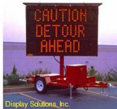
Figura 31 – Exemplos de PMV fixo de LED (esq.) e móvel com alimentação solar (dir.)
