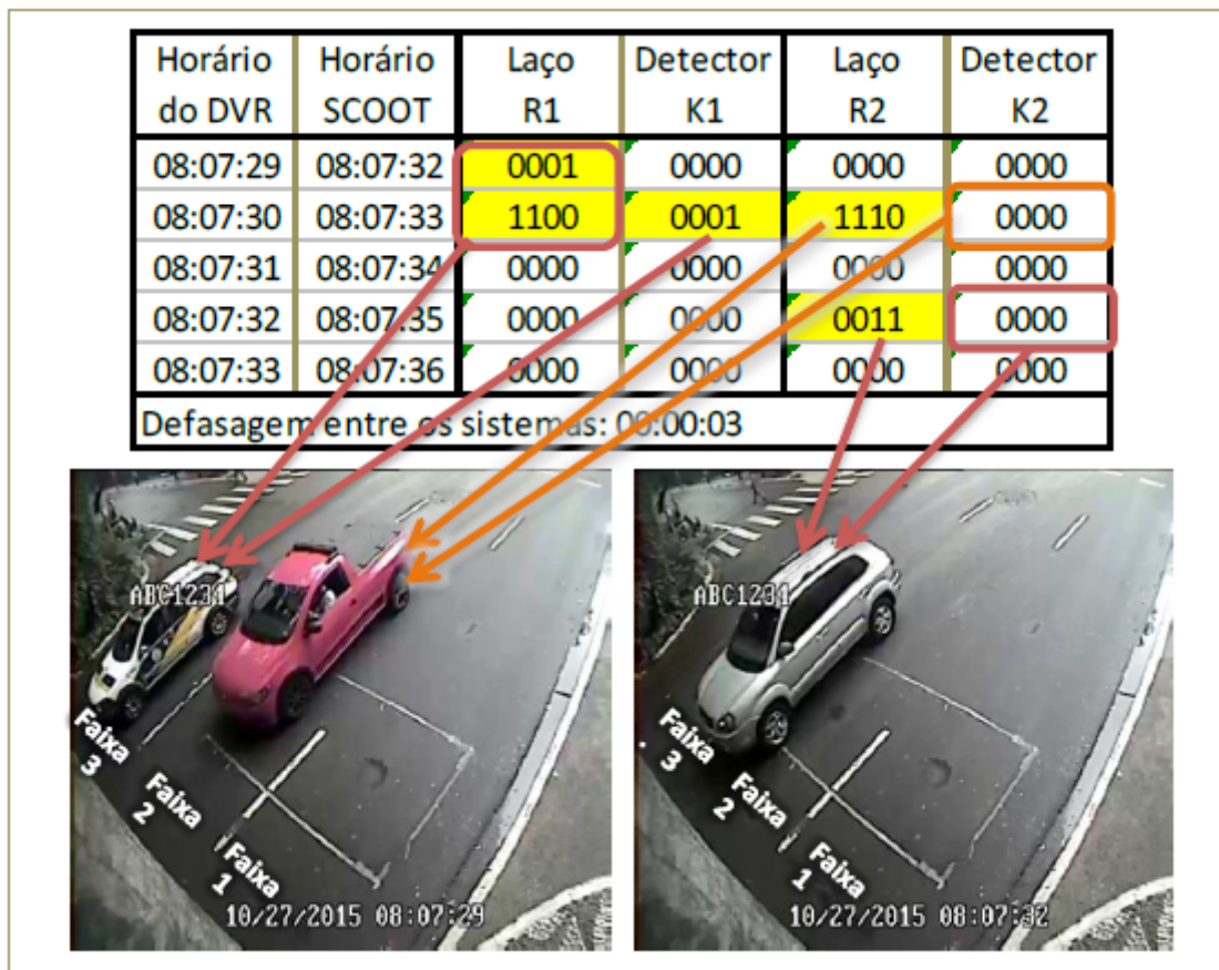
Figura 28 - Exemplos de sub-registro e não identificação de veículos pelo sensor da empresa D
