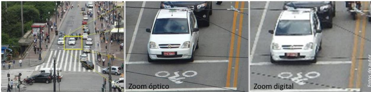
Figura 155. Comparação entre zoom óptico e zoom digital, ambos com fator de 8 vezes.
