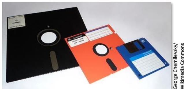
Figura 75. Um pouco de nostalgia: disquetes de 8 polegadas (IBM, 1971), 5¼" (Shugart Associates, 1976) e 3½" (Sony, 1983).
