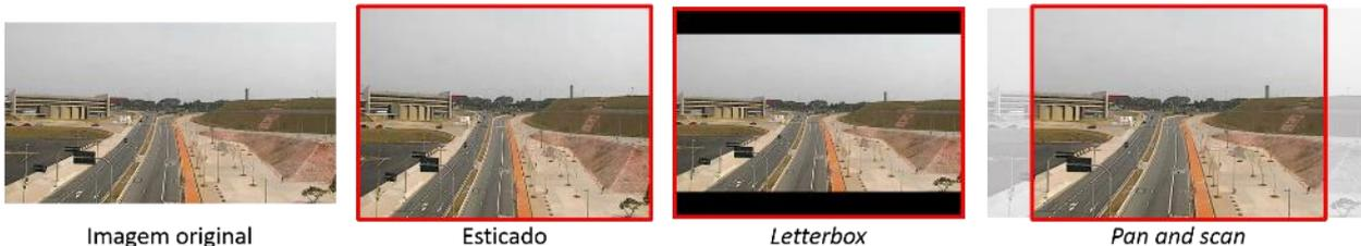
Figura 211. Adaptação de formato. As imagens da esquerda mostram o quadro capturado pela câmera. As outras três imagens mostram as alternativas de adaptações ao monitor (demarcado em vermelho).
