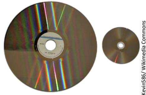
Figura 72. Comparação entre um LaserDisc (esq.) e um DVD.
