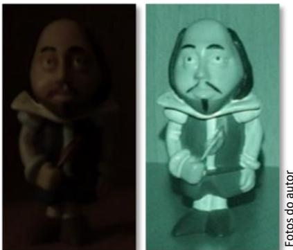
Figura 165. Objeto iluminado por fraca luz visível (esq.) e por um iluminador infravermelho.
