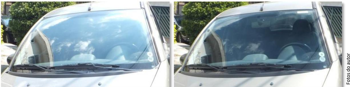
Figura 146. Lente com filtro polarizado (dir.) reduz grande parte do reflexo no para-brisa e permite ver o interior do veículo.
