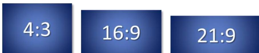
Figura 84. Comparação de formatos para telas com a mesma área.
