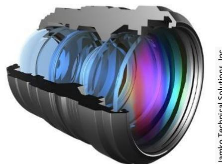
Figura 66. Vista em corte de uma lente composta moderna.
