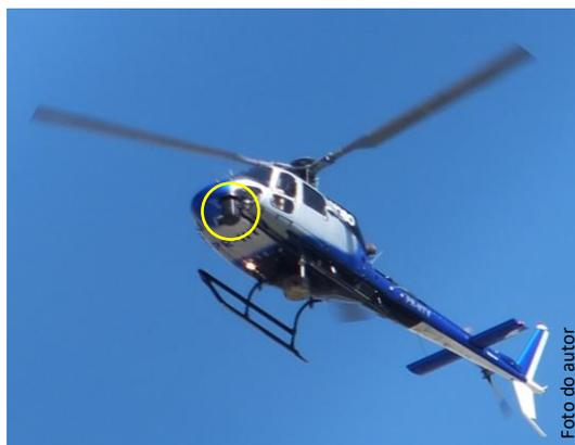
Figura 128. Câmera em helicóptero de emissora de TV.
