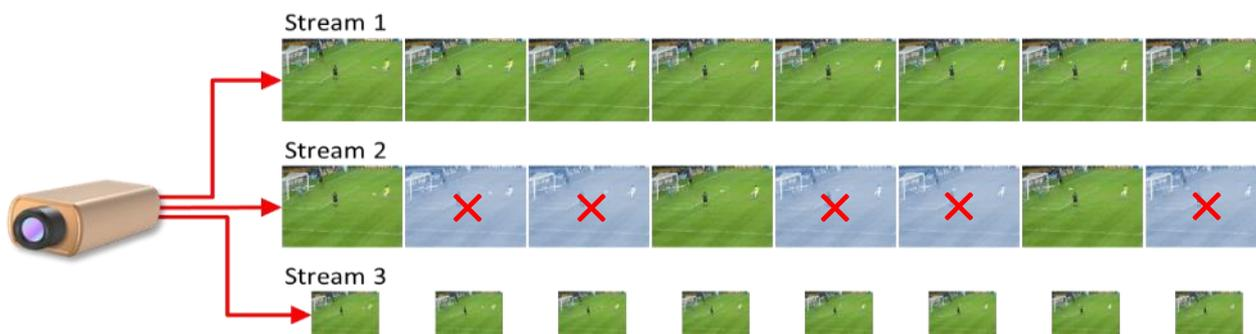
Figura 183. Exemplo de câmera com 3 streams.
