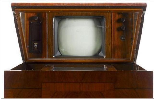
Figura 55. Televisor eletrônico mais antigo da Inglaterra ainda em funcionamento, um Marconi tipo 702 com tela de 12 polegadas, de 1936 (acima, aberto; ao lado, fechado). O tubo fica na caixa, virado para cima, com a imagem refletida em um espelho na tampa. Custava 100 libras (4 mil libras atualizadas).
