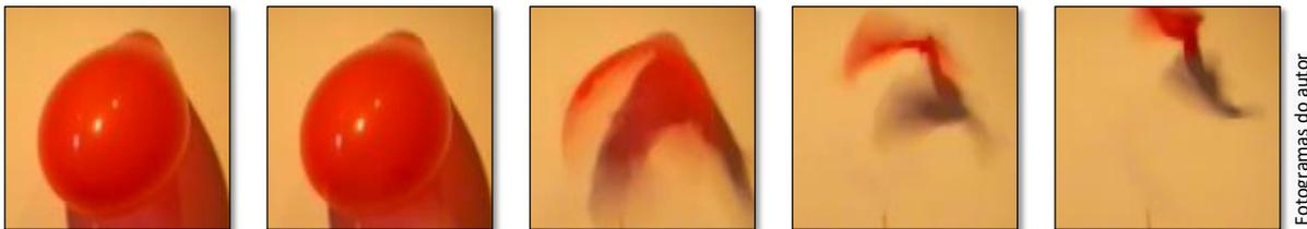
Figura 169. Estouro de balão gravado a 360 frames por segundo.
