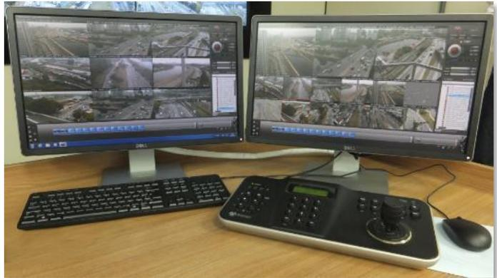
Figura 210, Estação de trabalho com dois monitores, teclado comum (esq.), mesa controladora (dir.) e mouse.
